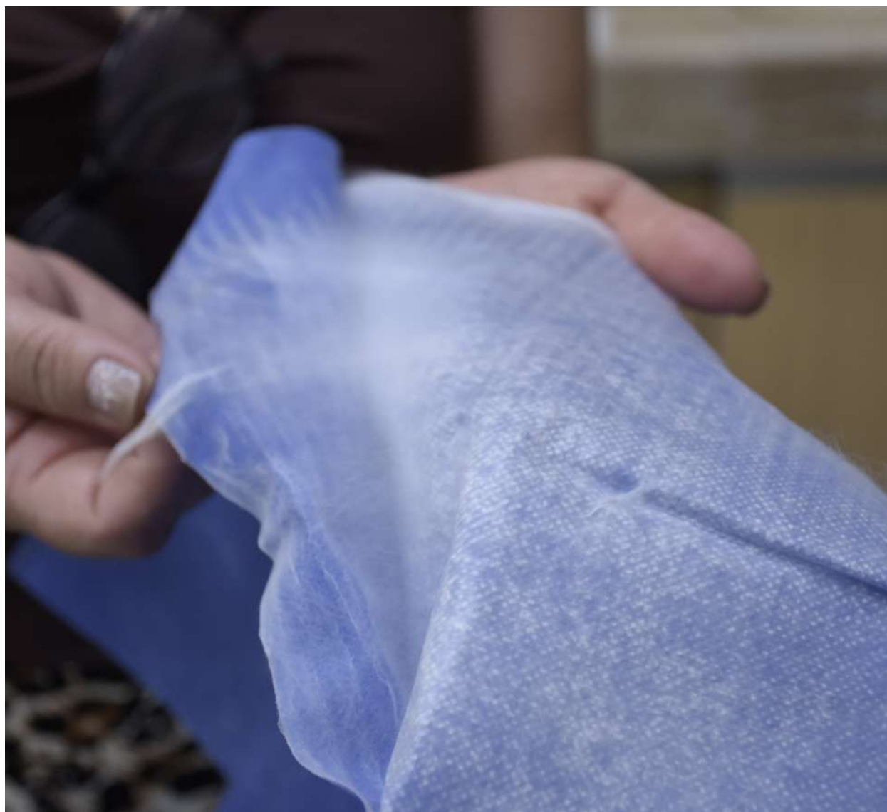
Detalle de las membranas con técnica de electrohilado.
